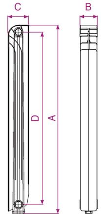
Les puissances thermiques des radiateurs sont conformes aux valeurs déterminées selon la norme EN442 en respectant les distances précisées ci-dessous:
